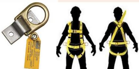
**Body – Soportes Corporales:** Los arneses de cuerpo completo proveen un punto de conexión al trabajador para el sistema de protección contra caídas. Dependiendo de la aplicación, ellos pueden ser usados como la parte del sistema que protege al trabajador durante una caída y limitar las lesiones potenciales en caso de que esta ocurra.
